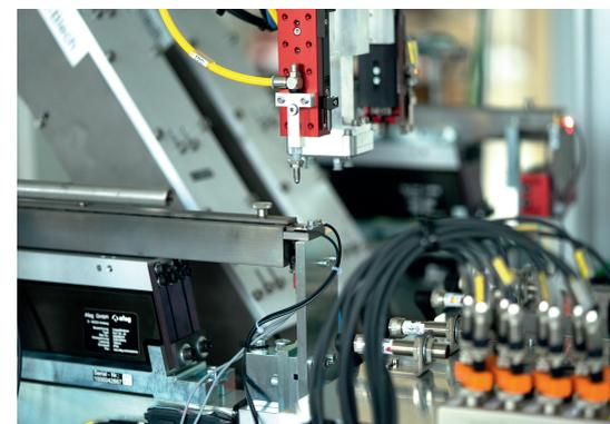
**Bild 1.** An der Dreifach-Greifeinheit erfolgt die Handhabung des Gewindebolzens via Vakuumbalgsauggreifer an einer vertikalen Linearachse. © Afag
